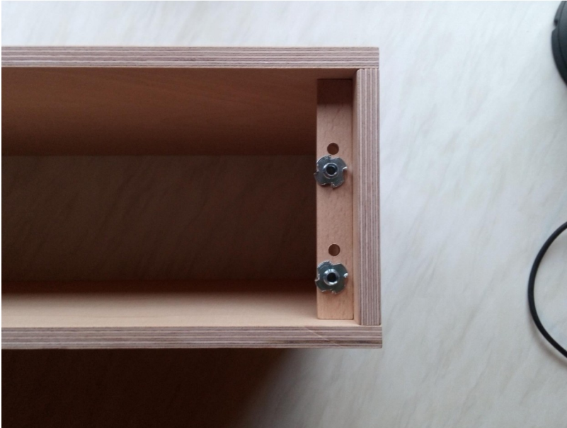
Bohrungen für Setzmuttern (werden von hinten montiert)
