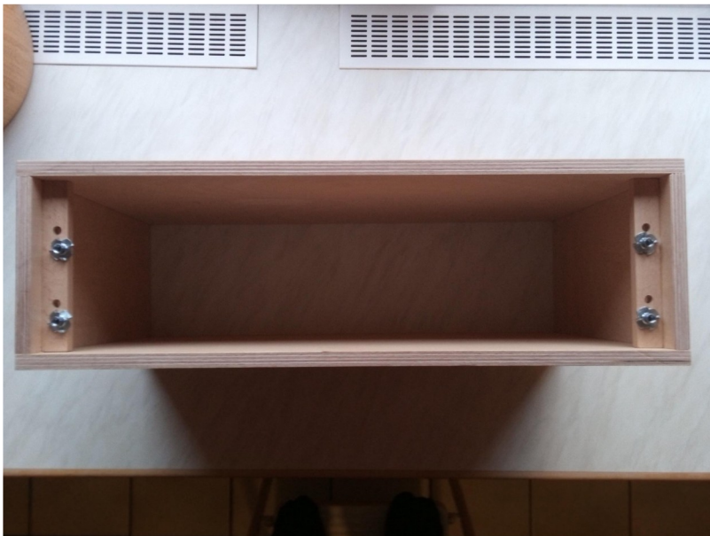
Bohrungen für Setzmuttern (werden von hinten montiert)
