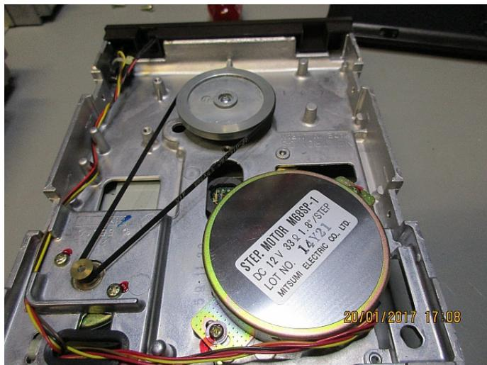
„Neues“ D500 Laufwerkschassis – Steppermotor und oben links Lichtschranke Teil 2
